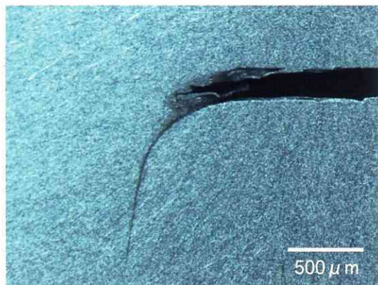
図4-1 着脱2000回後の試料断面 (20°, 0 μm)
