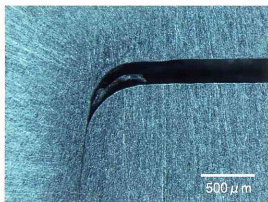
図4-2 着脱2000回後の試料断面 (40°, 200 μm)
