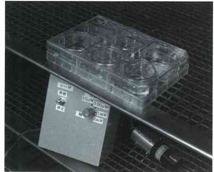
図3 光電変換色素膜上の培養細胞に対して, インキュベーター内でプレート下面からレーザー光照射を行っている様子
