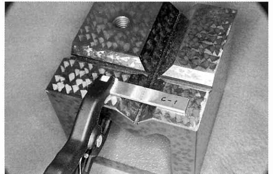
図2 枳形ブロック上で2枚の試料の短辺同士を突き合わせ、片方をクリップで固定する
