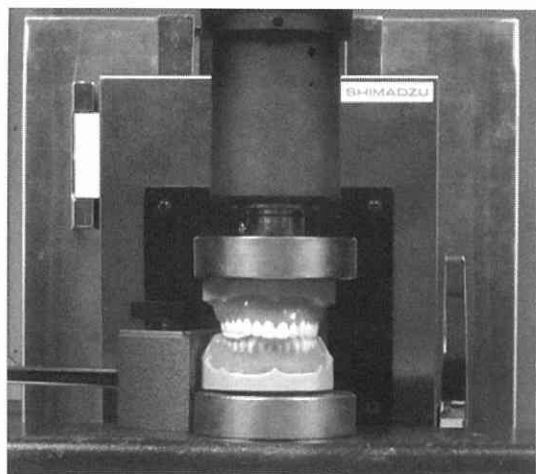
図5 実験用義歯を設置した万能試験機
