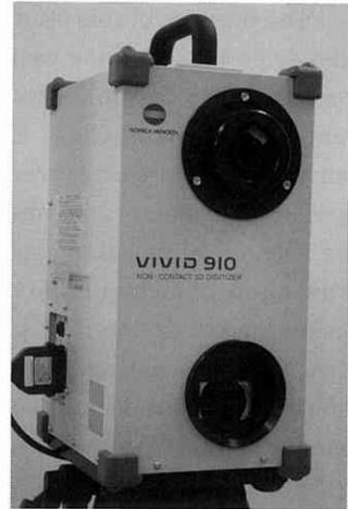
図1 非接触型三次元計測器 (Vivid 910)
