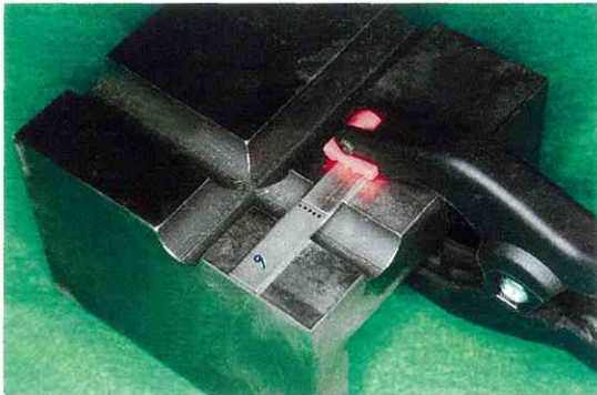
図3 溶接用ブロックとクリップで固定された試料
