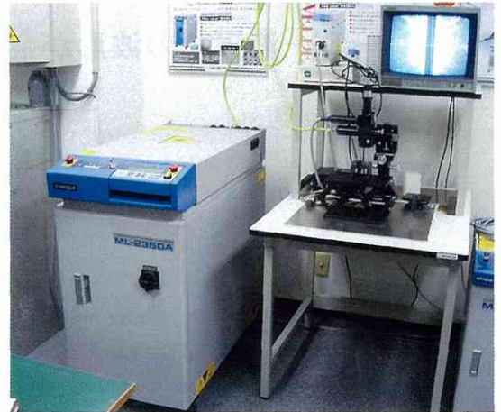
図1 使用したNd:YAGレーザー溶接機 ML-2350Aミヤチテクノス
