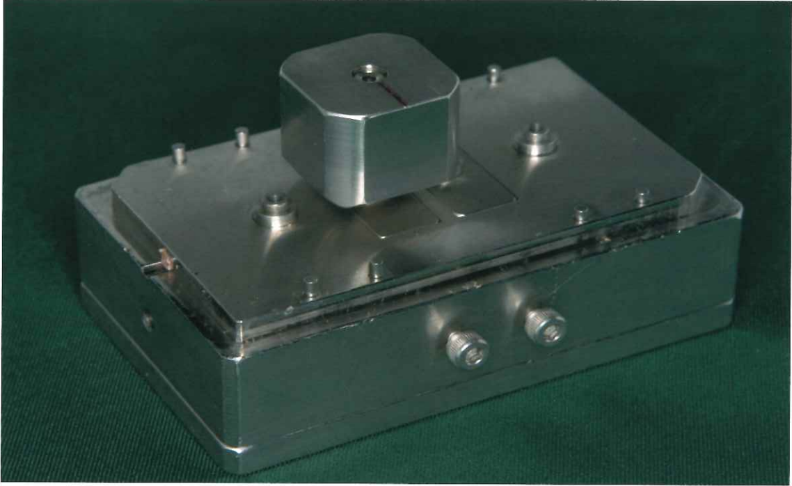
図9 基準模型上の回転量測定用ジグ
