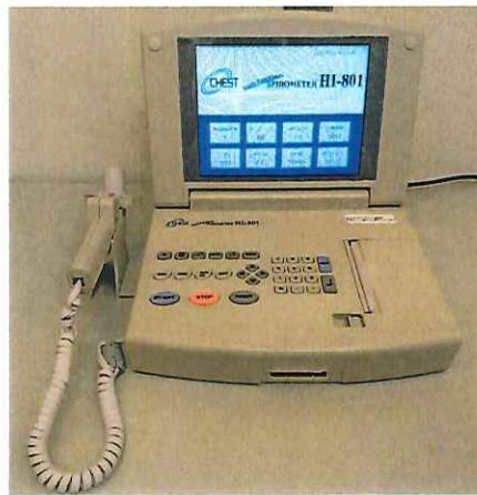
図8. スパイロメトリーの測定方法および努力呼気曲線 マルチファンクショナルスピロメーター HI-801 (CHEST社製) を用いてスパイロメトリーを測定した。 自然頭位にした座位姿勢にて, FEV 1 を算出した。
